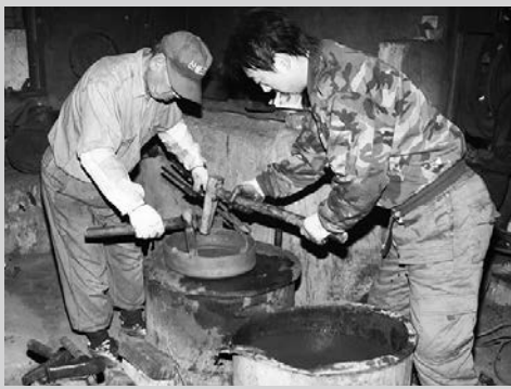
韓国金泉 錫 22%高錫青銅の熱間鍛造（銅鑲製作） 2008 年撮影
