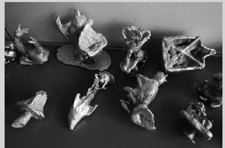
高岡市のづくりデザイン科 戸出中学校の生徒が鑄造した錫作品 (石膏鑄型・蠟型鑄造法: 錫は低融点でガスコンロで熔ける) 2010 年度
