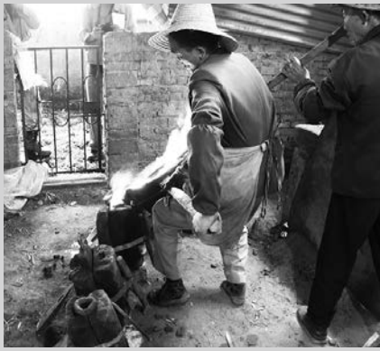
中国雲南省 鑄鉄の鋤先鑄造 (石製鑄型で連続鑄造) 2005 年撮影
