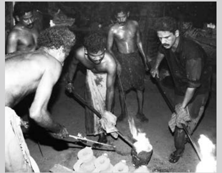
南インド ケララ州 真土型蠟型鑄造 工房の鑄造風景（水差製作） 2009 年撮影
