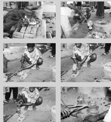
《参考資料》アルムラミラー 「坩堝・鋳型一体型鋳造」 1：坩堝を下で熔解 2：熔解炉から取り出す 3～5：ゆっくりと反転する 6：坩堝が上になった状態
