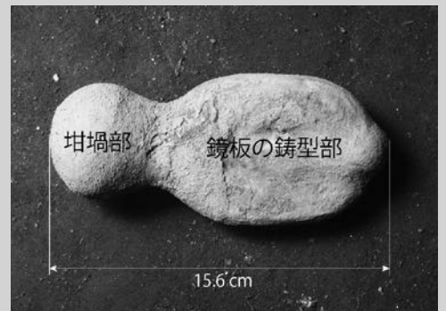
南インド アランムラ高錫青銅鏡の一体型の坩堝と鑄型
