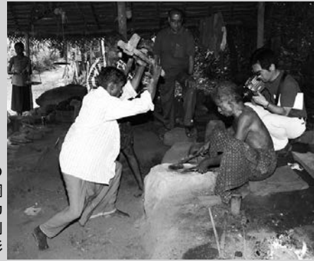
南インド ケララ州の 錫 22% の高錫青銅 熱間鍛造のサーモカ メラによる温度計測 2009 年撮影
