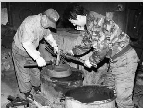
韓国金泉 錫 22%高錫青銅の熱間鍛造（銅鑲製作） 2008 年撮影
